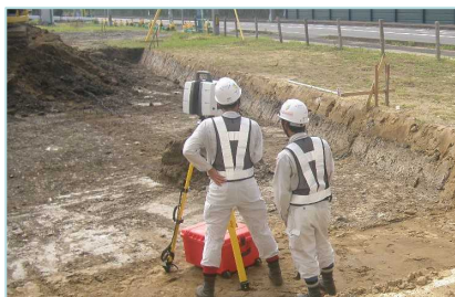
レーザースキャナー測量とUAV測量の検証を行い。 現場での実効性・精度を確認
