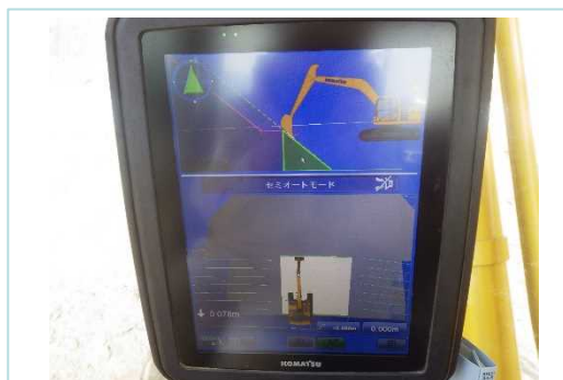
コントロールボックス (情報化施工専用モニタ)
