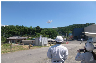
レーザースキャナー測量とUAV測量の検証を行い。 現場での実効性・精度を確認
