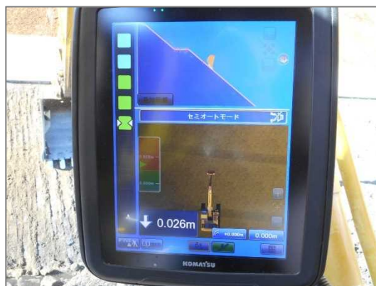
コントロールボックス (情報化施工専用モニタ)
