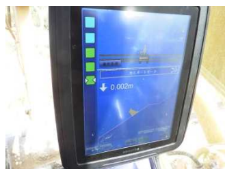
3DMCバックホーによる法面整形モニター確認
