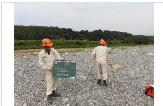
レーザースキャナ機器の精度を検証
