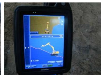
3DMCバックホーによる 掘削(土砂)モニター確認
