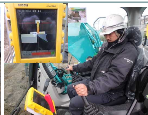
MGバックホーによる 施工基面整形
