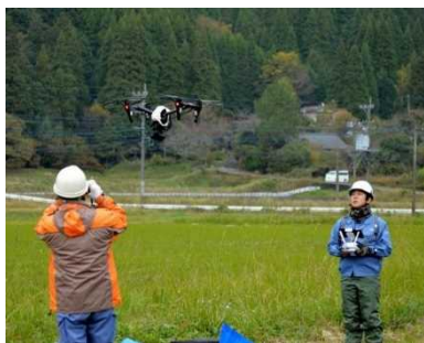
3次元起工測量UAV(ドローン)実施
